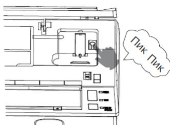
Для выключения кондиционера нажмите на кнопку **EMERGENCY SWITCH**. При этом Вы услышите одиночный звуковой сигнал, подтверждающий выключение кондиционера.
